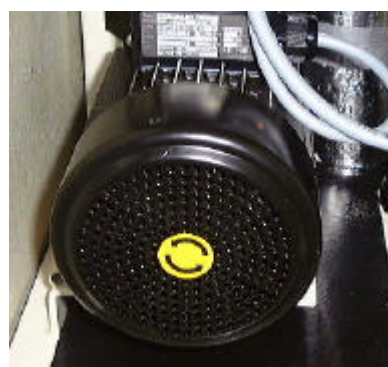
Kuva 13. Pumpun pyörimissuuntanuoli ( ylhäällä ) sekä täyttöventtiilit ja täyttöpullo laitteen oikealta sivulta kuvattuna ( vasemmalla )
