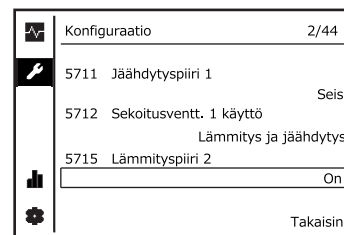
Kytke lämmityspiiri 2 päälle (On) riviltä 5715.
