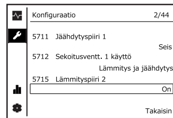
Kytke lämmityspiiri 2 päälle ( On ) riviltä 5715.
